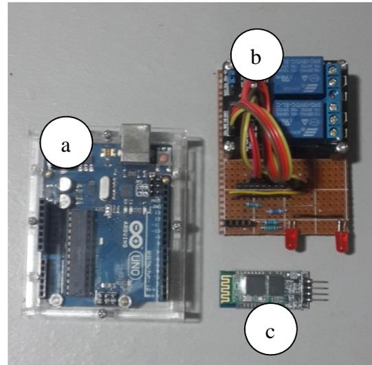
Fig. 4: a) Arduino Uno R3. b) Relay module. c) Bluetooth module.
